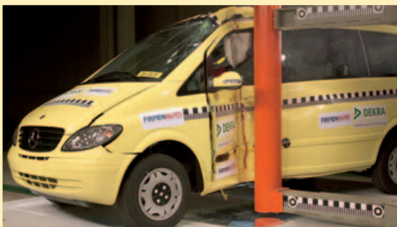
Pfahltest: Weil hier keine Crashzone vorhanden ist, muss sich der Kopfairbag innerhalb von nur acht Millisekunden entfalten
