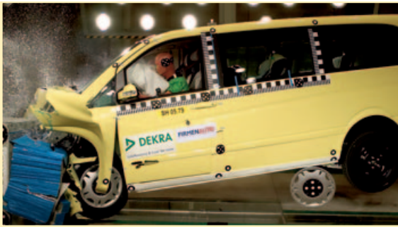
Frontal gegen die Barriere: Mit 64 km/h knallt der Mercedes-Benz Viano auf das Hindernis. In Sekundenbruchteilen geht der Airbag auf
