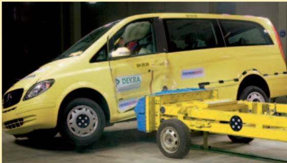
Volle Breitseite: Mit Tempo 50 rast der Prallwagen gegen die Seitenwand. Spektakulär neigt sich der große Van zur Seite, kippt aber nicht um
